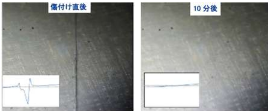
図4 自己修復コーティング、挿入図は表面粗さを示す
