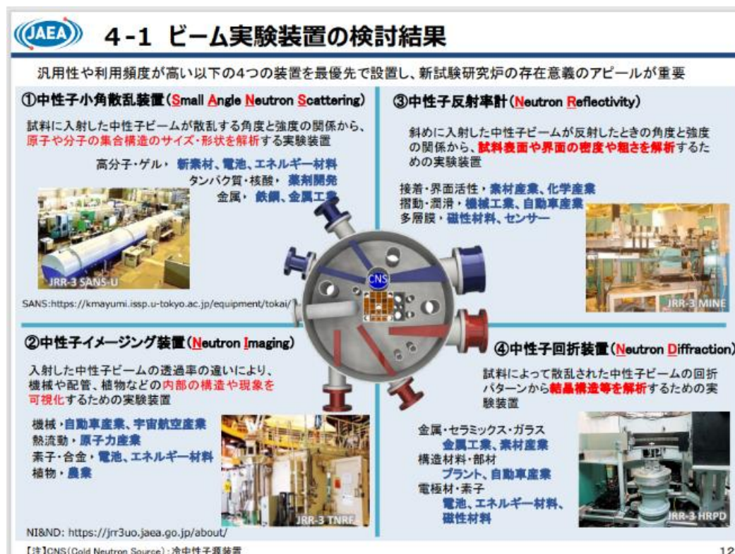
図2 概念設計の結果（装置検討）
