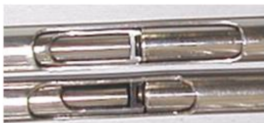
内部構造 (ステンレス 2 重カプセル)
