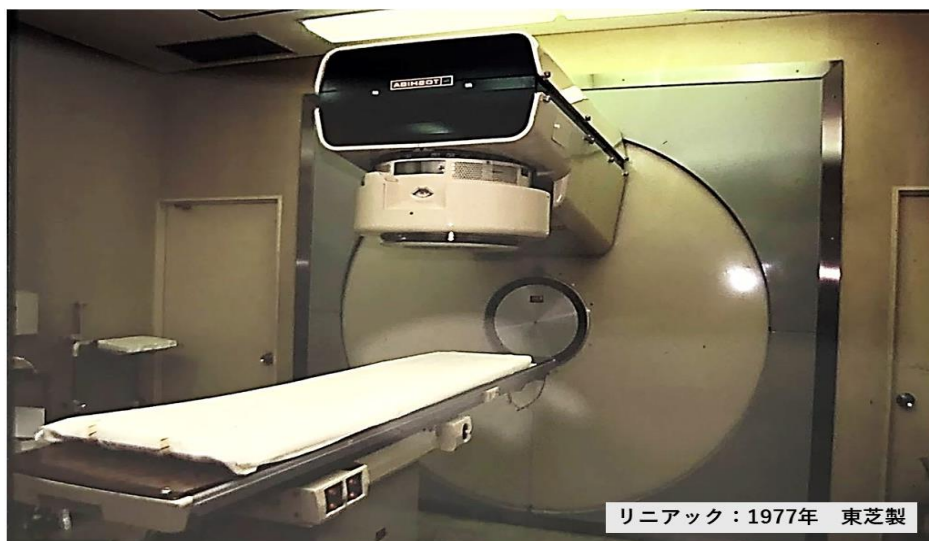
図-2：1970年代頃のリニアック装置*
