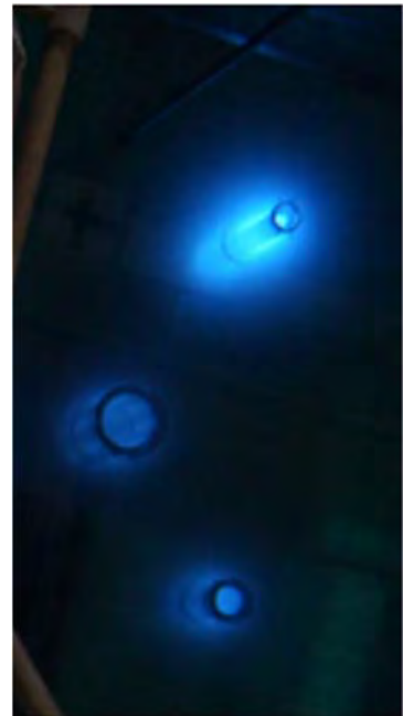
図 1. 線源棟コバルト 60 ガンマ線照射プール水中の線源からのチェレンコフ光
