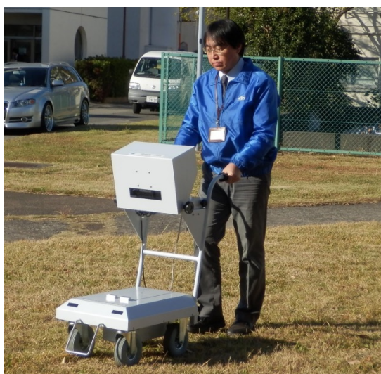
図 6: PEN を用いた高速ホットスポットモニター。従来のサーベイメータよりも測定スピードを 10 倍近く上げ、移動しながら探査が可能となった。そ
