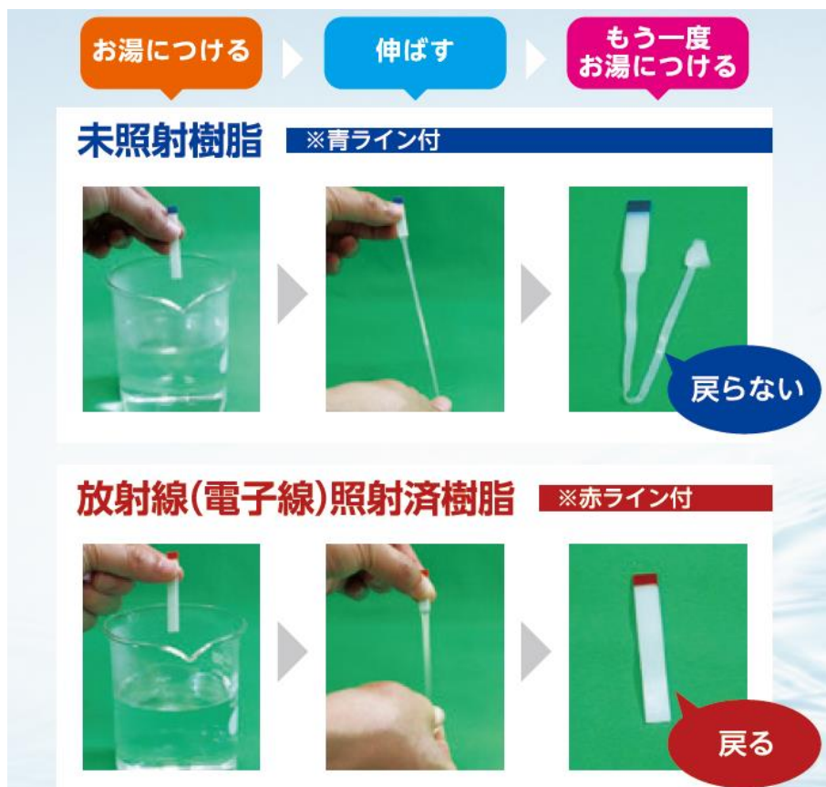
図 5 放射線(電子線)実験樹脂の概要
