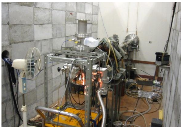
図1 大阪府大・電子リニアック加速器のビームラインに設置された照射チェンバー
