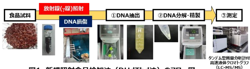
図1 新規照射食品検知法 (DHdThd法) のフロー図
