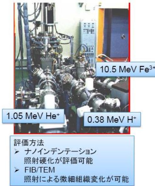
図4 QST 高崎研 TIARA 加速器に設置されたトリプルビーム照射装置。
