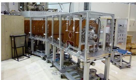
図2 陽電子ビームラインの性能確認: ビーム発生 K. Sato et al., Nucl. Instrum. Methods Phys. Res. B 342 (2015) 102.
