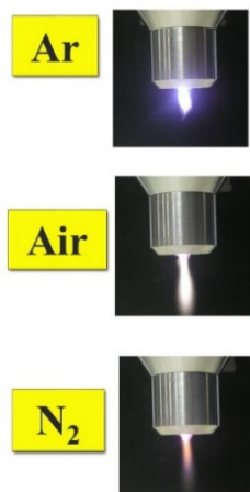
図 2 プラズマの状態と分光分析の結果。
