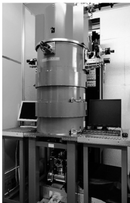
図2 フォトカソード高周波電子銃を用いた超高速電子顕微鏡実証機の写真(左)と構成図(右)。
