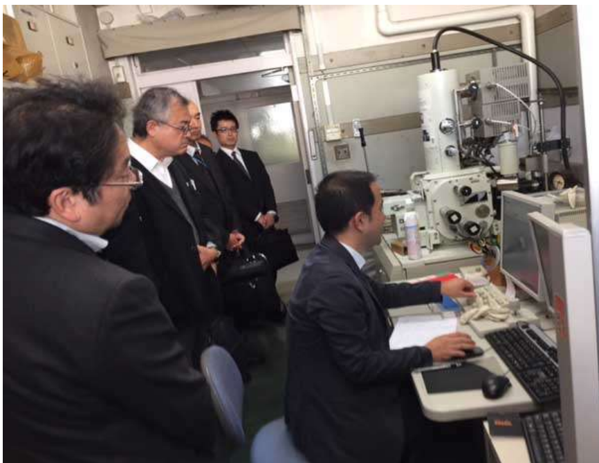
写真 2 ECCI のために SEM を操作する兼子先生
