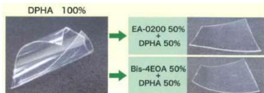
図4 光硬化型樹脂であるジペンタエリスリトールヘキサアクリレート (DPHA) のEA-200 添加による硬化収縮防止
