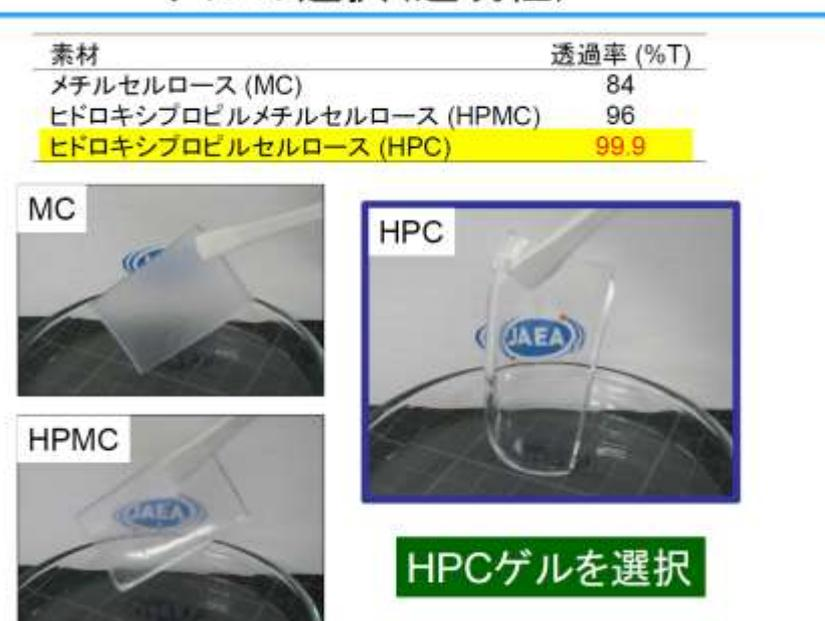
図 2 ゲル候補材の光透過率の比較
