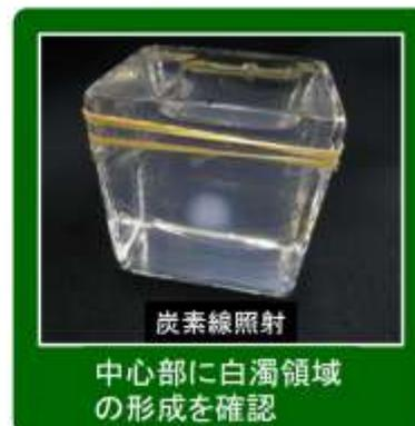
図 3 立体形状ゲル線量計の試作例
