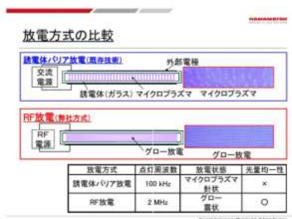
図 4 誘電体バリア放電（既存技術）と RF 放電（浜松ホトニクス社）方式の比較
