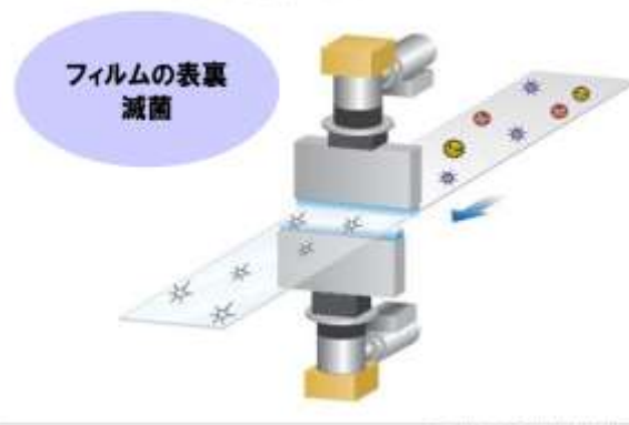
図 3 2 台の EB-ENGINE を用いたフィルムの表裏滅菌の例
