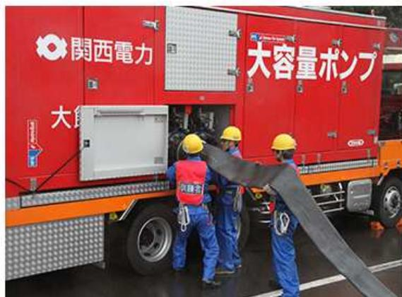
原子炉に冷却水を注入するためのポンプの設置訓練
